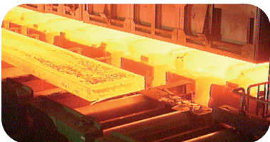
Weißblechdosen aus der Wertstoffsammlung werden geschmolzen, gegossen und platt gewalzt
