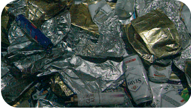
gepresste Aluminium-Verpackung aus der Wertstoffsammlung, bereit zum Zerkleinern und anschließenden Einschmelzen
