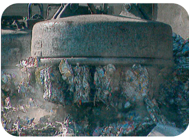
Magnetabscheider: ein überdimensionaler Magnet sortiert Weißblechdosen aus der Wertstoffsammlung aus
