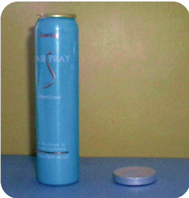
rechts: Ausgangsmaterial Aluminiumscheibe, links: ausgeformte Aluminium-Spraydose
